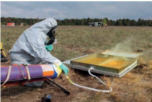
Abbildung 3: Freisetzen von flüssigem Chlor mittels beheizbarer Metallwanne
