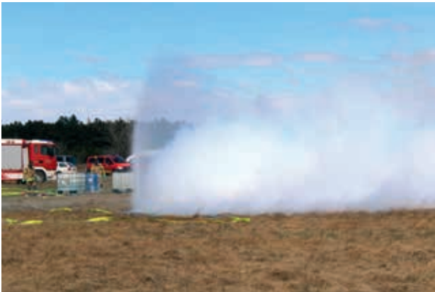
Abbildung 7: Reaktion von Chlor mit Ammoniumhydroxidlösung bei der Aufbringung über ein Hydroschild
