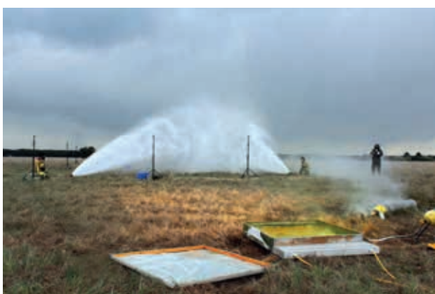
Abbildung 6: Dispersionsversuche von Chlor durch den Einsatz von Wasserwerfern (jeweils 800 l/min)
