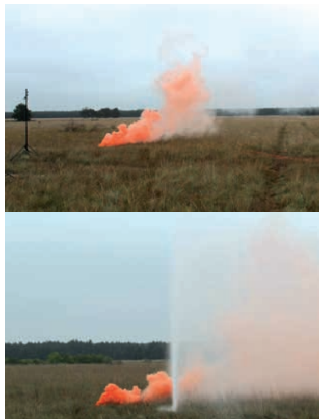
Abbildung 4: Einsatz von Tracerpartikeln zur Darstellung des Durchbrechens von schwerlöslichen Gasen beim Hydroschild
