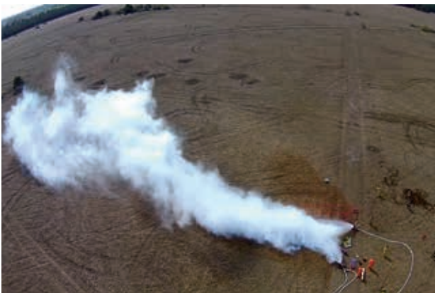
Abbildung 8: Reaktion von Chlor mit Ammoniumhydroxid bei der Aufbringung durch Wasserwerfer (je 1.200 l/min)
