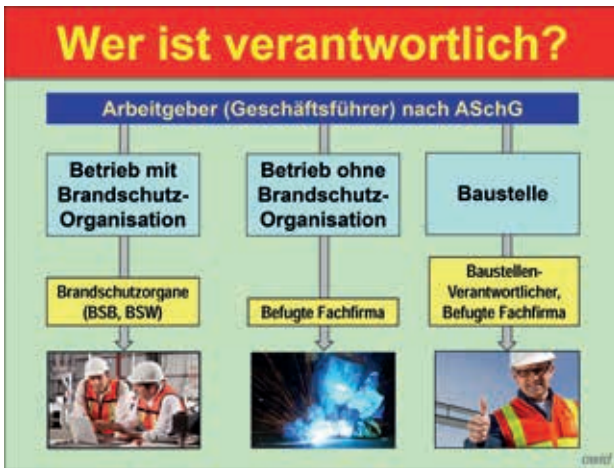
Verantwortungsverhältnisse bei feuergefährlichen Arbeiten.
