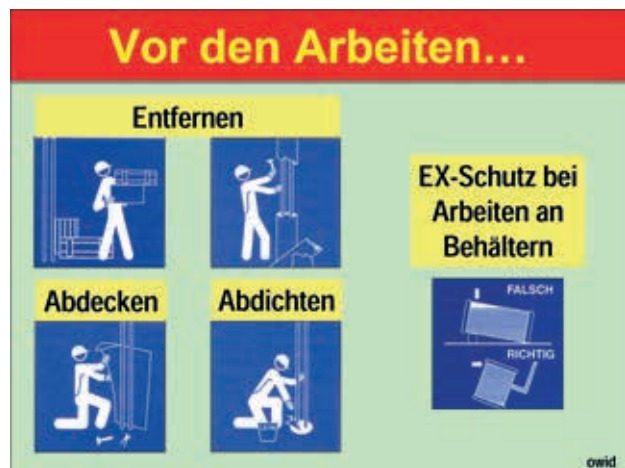
Wichtige Maßnahmen vor den brandgefährlichen Arbeiten exemplarisch.
