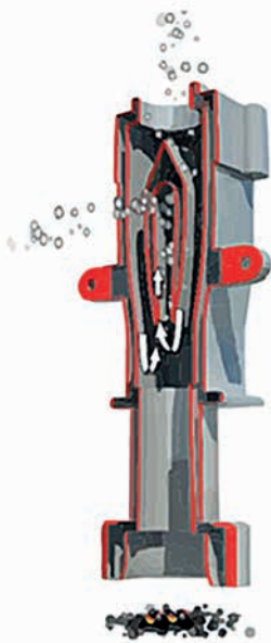
Bild 2. Filtersystem für Staubpartikel und Schmutz; FAAST 8100E.
