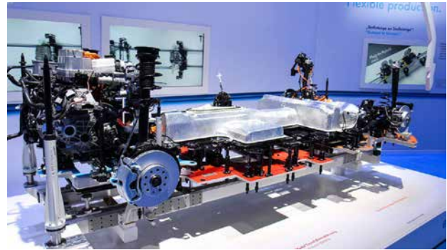
Der Antriebsstrang des e-Golfs. Wo früher Tank und Kardantunnel Platz fanden gibt es heute: Grillschale und Akkupack. (Quelle: Autorevue.at)
