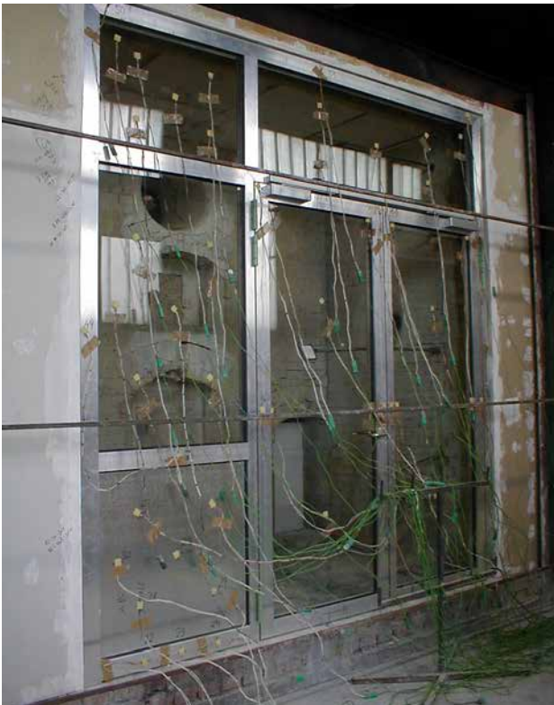
Abbildung 2: verglaste Türe mit Seiten- und Oberteilen vor der Feuerwiderstandsprüfung (Quelle: MA 39)
