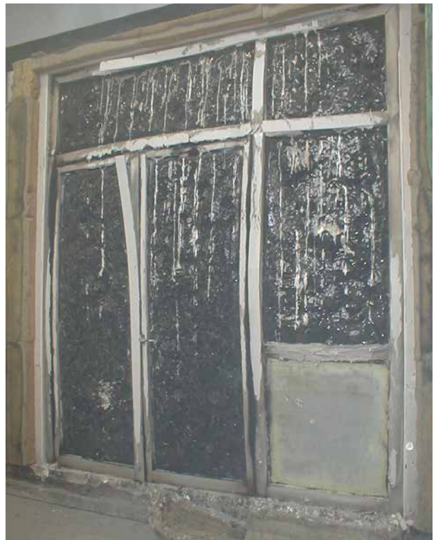
Abbildung 5: verglaste Türe mit Seiten- und Oberteilen nach der Feuerwiderstandsprüfung – brandraumseitige Ansicht (Quelle: MA 39)
