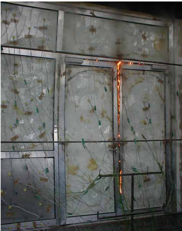
Abbildung 4: verglaste Türe mit Seiten- und Oberteilen zum Ende der Feuerwiderstandsprüfung (Quelle: MA 39)
