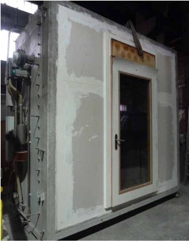
Abbildung 6: verglaste Türe vor der Rauchschutzprüfung (Quelle: MA 39)
