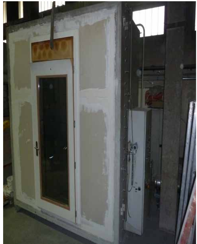
Abbildung 7: verglaste Türe während der Rauchschutzprüfung (Quelle: MA 39)
