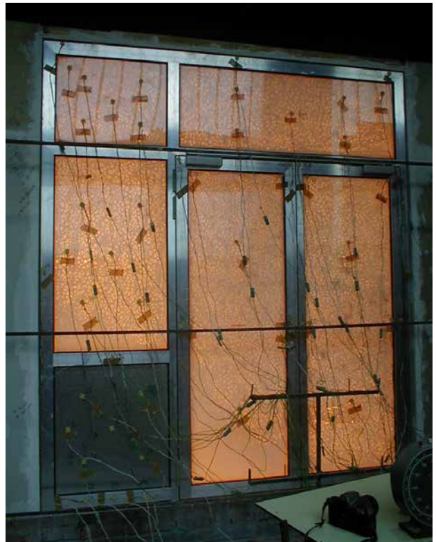
Abbildung 3: verglaste Türe mit Seiten- und Oberteilen während der Feuerwiderstandsprüfung (Quelle: MA 39)
