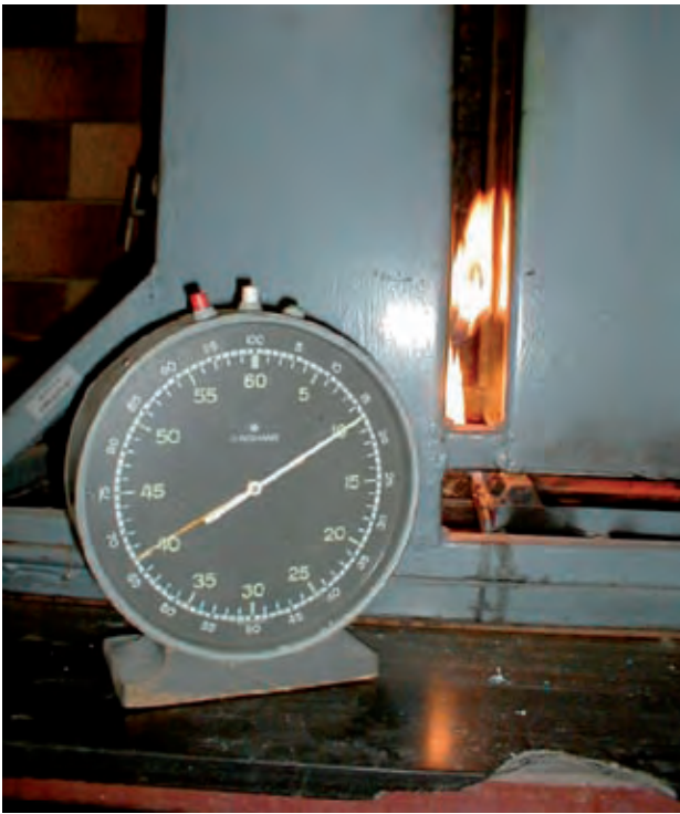
Abbildung 1: Prüfung im Schlytertest nach ÖNORM A 3800-1
