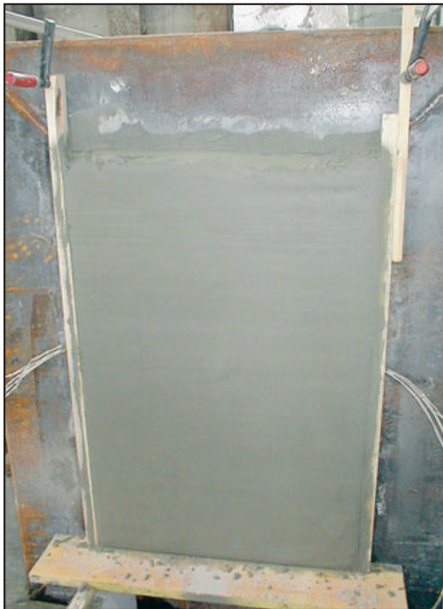
Abbildung 8: Fertig aufgetragene Schutzschicht
