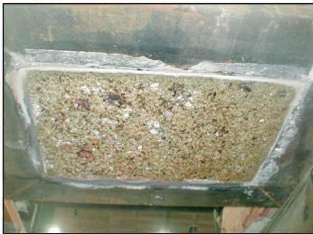
Abbildung 6: Prüfkörper nach dem Brandversuch - geringfügigste Betonabplatzungen
